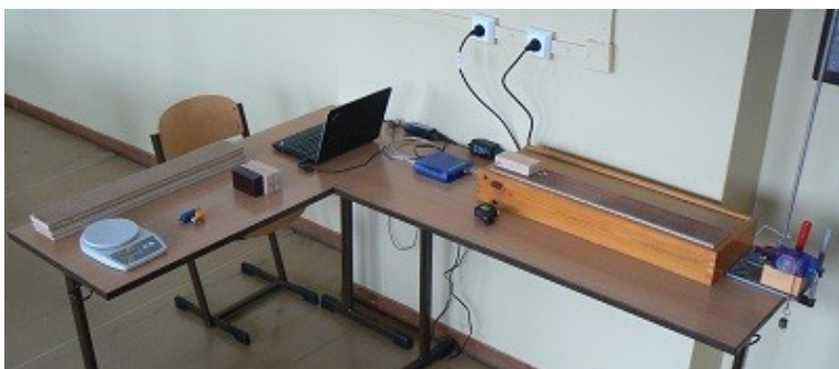
Jedna z možností celkového uspořádání pracoviště pro měření koeficientu tření a detail upevnění rotačního snímače na stojan.
