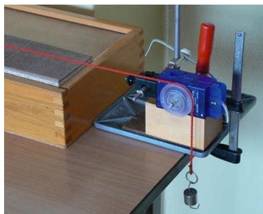
Jedna z možností celkového uspořádání pracoviště pro měření koeficientu tření a detail upevnění rotačního snímače na stojan.
